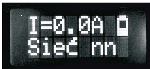
Praca w trybie niskiego napięcia - na wyświetlaczu widzimy wartość mierzonego przepływającego prądu przez cęgi oraz wskazanie stanu naładowania akumulatora
